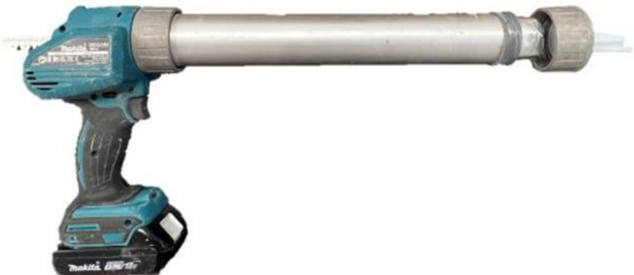
Figure 6 – Insertion de la poche dans le pistolet et vissage de la canule
